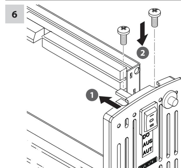
Anschluss des neuen Resettaster mit Gewindebefestigung, lang und Programmschalter – Seitenteil beim Trafo
