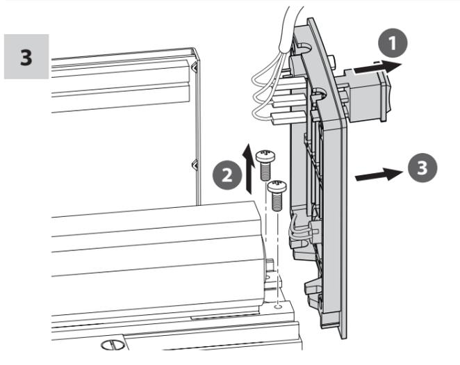
**Neuen Resettaster, Programmschalter und neues Seitenteil wieder einbauen**
