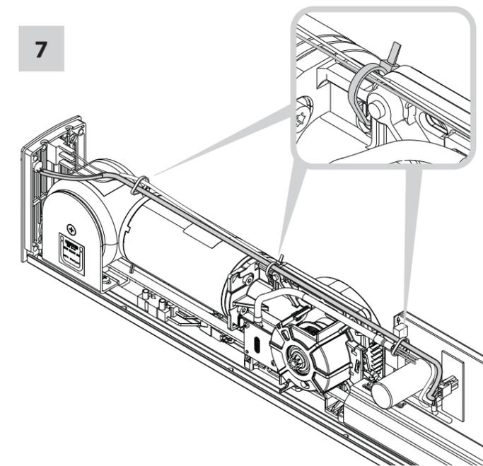
▸ Kabel mit Kabelbinder sichern.
